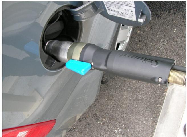
Nach dem Tanken den Hebel wieder nach links (vom Auto weg) drehen, ein paar Sekunden warten und dann die Kupplung abziehen. Lässt sie sich nicht leicht abziehen, einfach die Kupplung nochmal auf den Tankstutzen drücken, damit sich die innliegende, nicht zugreifbare Hülse zurückzieht. Kupplung abnehmen und an die Säule zurückstecken.
