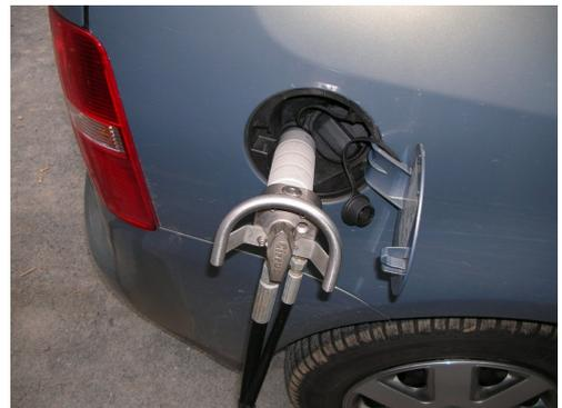
Dann den Drehknopf an der Kupplung ganz (=eine halbe Umdrehung) nach links drehen. Jetzt kann getankt werden.
