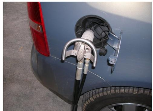
Nach dem Tanken den Drehknopf wieder ganz nach rechts drehen. Die dicke, geriffelte Hülse zurückziehen, dann lässt sich die Kupplung abnehmen.
